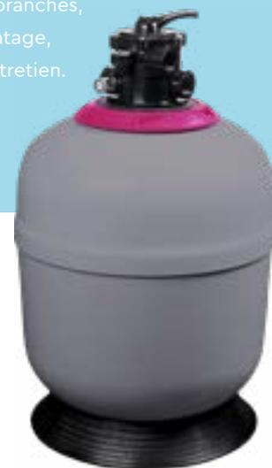
\*Pour les filtres 920 équipés d'une vanne 2", compte tenu des pertes de charge engendrées, il est conseillé de ne pas dépasser un débit de 26 m³/h (la vitesse de passage, à ce débit, est d'environ 40 m³/h/m²).
