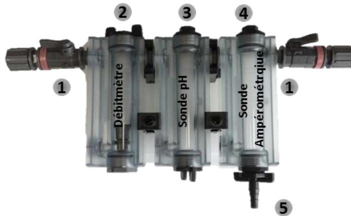
❶ les vannes d'isolement amont et aval de la chambre de passage facilitent les phases d'étalonnage et de maintenance. La vanne amont permet de régler le débit sur la chambre de passage.
