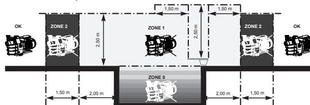
Installer la pompe dans un local ventilé et sec, le moteur exige que l'air circule librement autour de celle-ci pour permettre sa ventilation naturelle. Prévoir un dégagement minimum de 0,5 m autour de la pompe. Vérifier régulièrement que des objets, des feuilles ou tout autre encombrant ne viennent pas obstruer le refroidissement du moteur.
