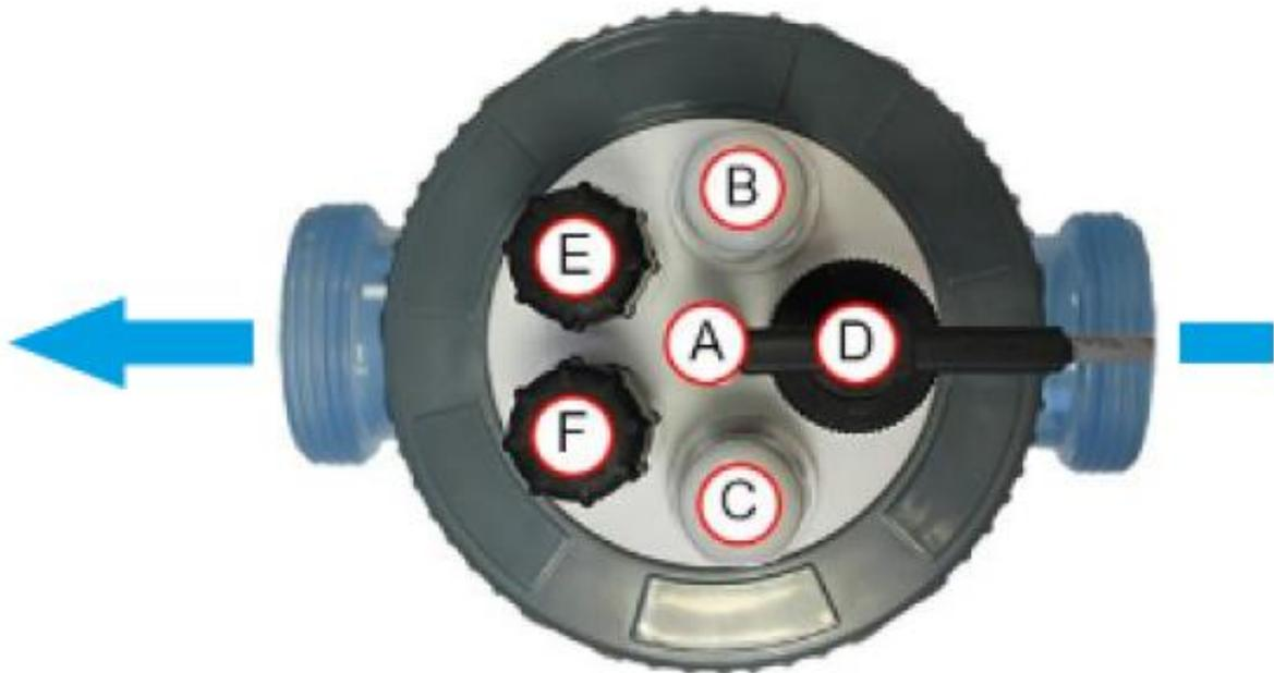
**A : Pool-Terre.** Raccorder le pool-terre du ZELIA POD sur un piquet indépendant. Veillez à réaliser une bonne prise de terre : la qualité de la mesure et la durée de vie des sondes en seront grandement améliorées.
