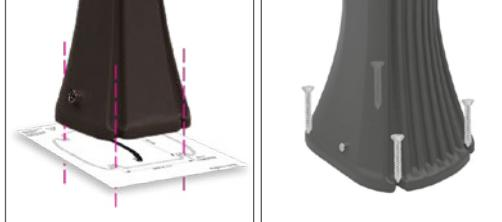
3. Setzen Sie die Dübel ein und befestigen Sie die Solardusche senkrecht mit einer Wasserwaage, korrigieren Sie die Vertikalität ggf. mit Unterlegscheiben.
