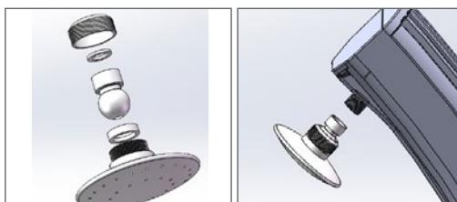
4. Montieren Sie den Duschkopf mit den mitgelieferten Verbindungen. Drehen Sie den Duschkopf in den Duschkörper.
