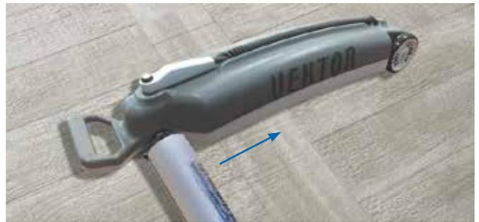
Une fois le carré d'enroulement installé dans **VEKTOR 1**, enfillez-le en butée dans le tube de la couverture à barres. L'enroulement de la couverture se fait par simple pression sur la télécommande. Une fois la couverture à barres parfaitement enroulée, presser la fonction Reverse côté roues afin de séparer cette dernière de **VEKTOR 1**. Après avoir enroulé la couverture à barres, **VEKTOR 1** se recharge sur son support mural ! Pratique !
