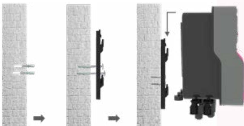
L'appareil BWT EasyDose se fixe facilement au mur grâce à la platine de fixation et les vis qui sont fournies avec l'appareil.
