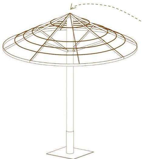
Posez l'armature sur le mât et fixez les jambes de force à l'armature puis au collier de serrage à l'aide de 2 boulons 8x20mm et 2 boulons 8x30mm. Ces derniers permettent d'assembler les deux parties du collier.
