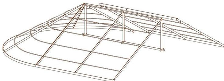
Puis, assemblez à l'armature les 2 ou 3 triangles métalliques pour faire l'arrondi de l'autre côté et fixez les jambes de forces. Afin de faciliter la pose, fixez les têtes de poteaux à l'armature.
