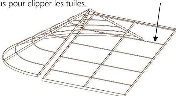
Ensuite, assemblez le rectangle de contreventement, pattes de fixation des jambes de force vers le bas et le deuxième rectangle métallique. Les modèles 2,20 x 3,40 m et 2,40 x 3,60 m n'ont pas de rectangle de contreventement.
