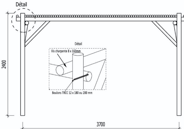
Puis, fixez les 4 pannes de 4 m sur les traverses de 3 m avec les vis charpente de 8x160mm fournies.
