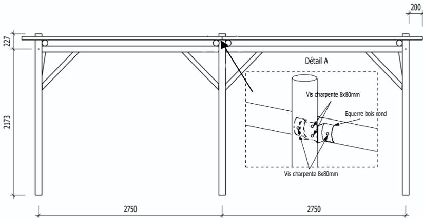
Ensuite, vérifiez l'équerrage des poteaux puis fixez les jambes de forces de 80cm aux poteaux et à la traverse avec les vis charpente de 8x100mm fournies.
