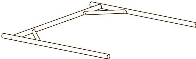
Puis, sur l'un des portiques, fixez les équerres pour bois rond à chaque extrémité de la traverse avec les vis charpente de 6x50mm fournies.
