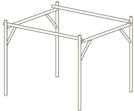
Ensuite, fixez les jambes de force de 86cm aux poteaux et aux pannes avec les vis charpente de 8x100mm fournies.
