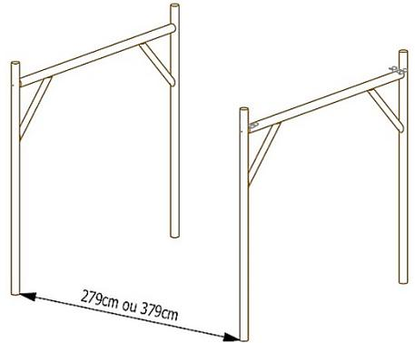
Puis, fixez les pannes (de 300cm pour le Lapa 6x3m et de 400cm pour le Lapa 8x3m) aux poteaux avec les vis charpente de 8x160mm fournies, et aux équerres avec les vis charpente de 6x50mm fournies.
