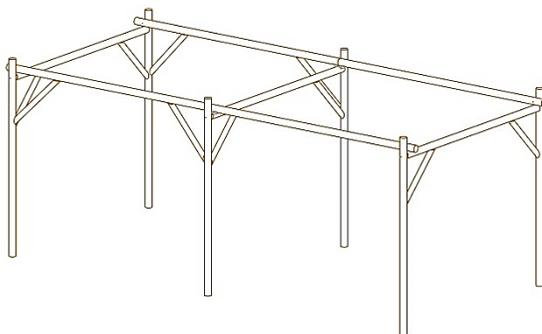
Ensuite, fixez les jambes de force de 86cm aux poteaux et aux pannes avec les vis charpente de 8x100mm fournies.
