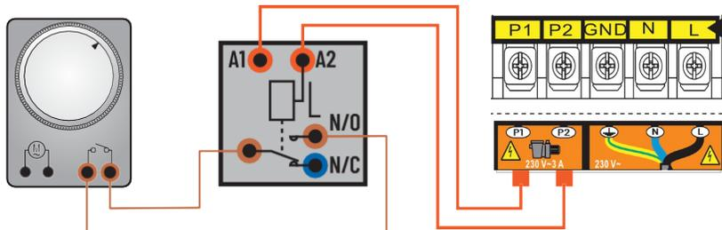
**Paramètre pour la prise en compte du branchement:** Vérifier que le réglage du paramètre de pompe de filtration (paramètre #9) soit bien réglé à «2». Dans le cas contraire, nous contacter pour modifier ce réglage .
