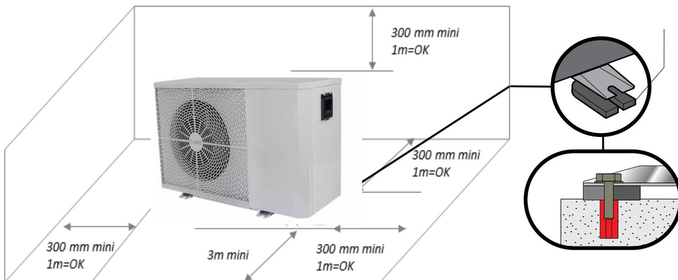
La PAC doit être installée en permanence sur un socle rigide et fixe en plaçant les patins fournis sous les pieds :
