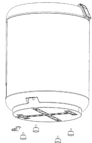
La PAC doit être installée en permanence sur un socle rigide et fixe en plaçant les patins fournis sous les pieds :
