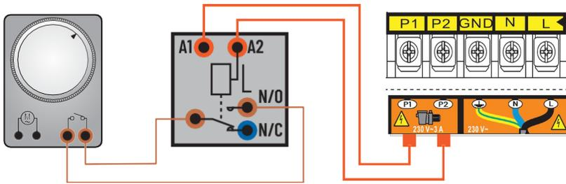
**Paramètre pour la prise en compte du branchement:** Vérifier que le réglage du paramètre de pompe de filtration (paramètre #9) soit bien réglé à "1". Dans le cas contraire, nous contacter pour modifier ce réglage .
